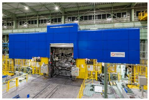
Новый HZ-стан с раздельной станиной от Primetals Technologies, установленный на заводе компании Nippon Yakin Kogyo, заменил два моноблочных стана холодной прокатки.
