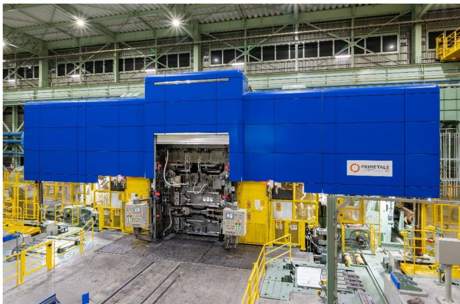
O novo laminador HZ com cadeira de laminação bipartida fornecido pela Primetals Technologies à Nippon Yakin Kogyo substituiu dois laminadores a frio monobloco.
