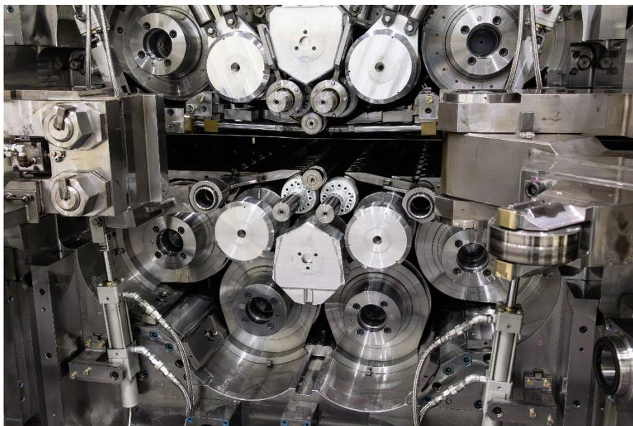
新建可逆式冷轧机能够以高达 1,000 米/分的轧制速度生产最小厚度只有 0.2 毫米的带卷。
