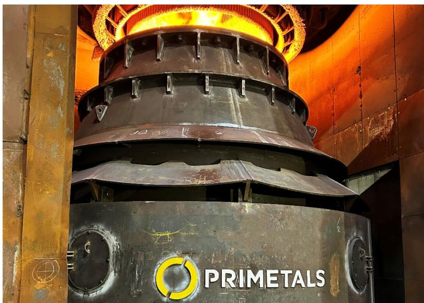
普锐特冶金技术为奥钢联多纳维茨厂改造的 4 号 LD 转炉(BOF)正在冶炼第一炉。
