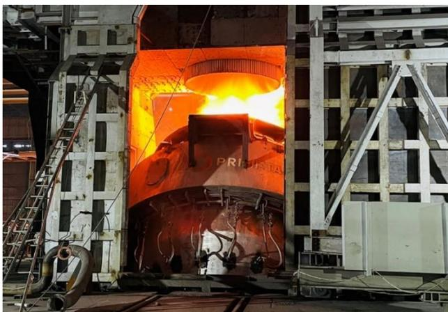
プライメタルズ テクノロジーズがインド、JSL 向け AOD 転炉と連続鋳造機を新設
