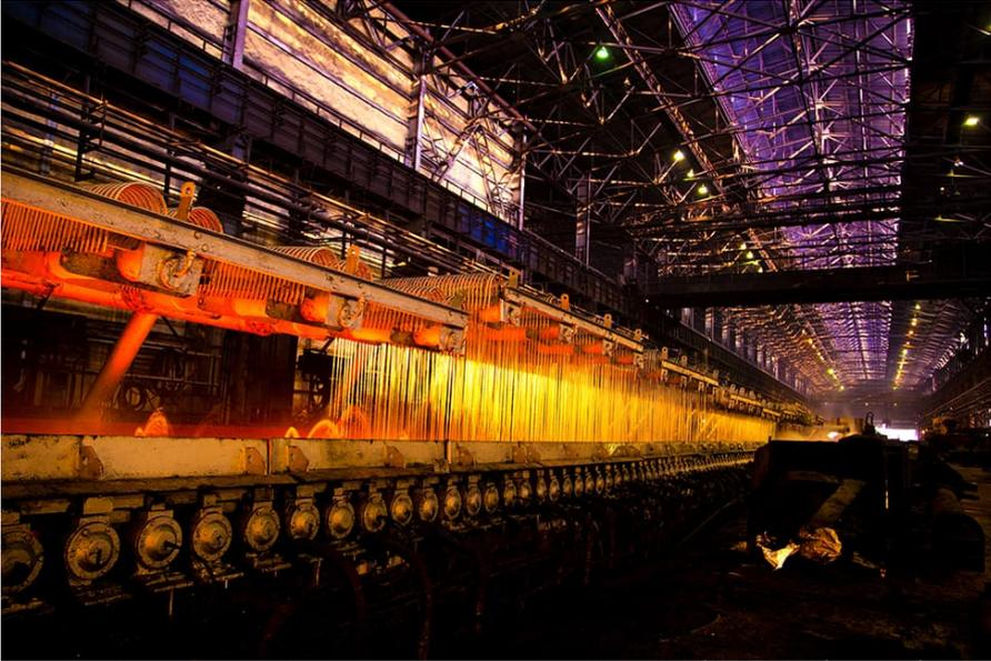
Seção de resfriamento da laminação de tiras a quente da SAIL Bokaro. A modernização pela Primetals Technologies abrangeu equipamentos de automação do laminador de acabamento, seção de resfriamento, bobinadeira e transportador de bobinas.
