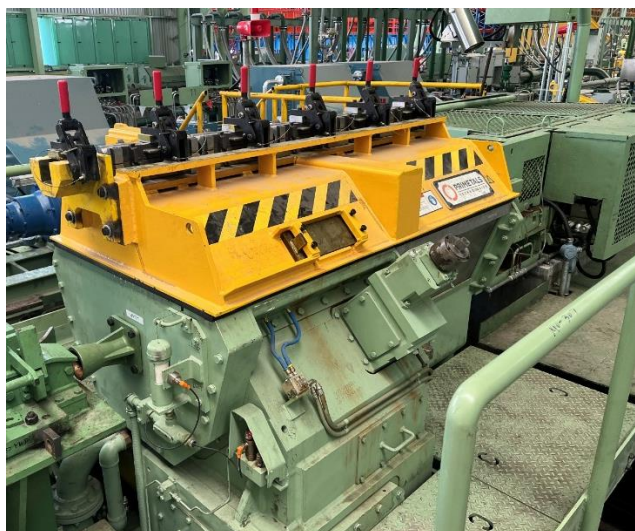
プライメタルズ テクノロジーズの最新ソリューションのひとつ、eDrive ミニ仕上げ圧延機
