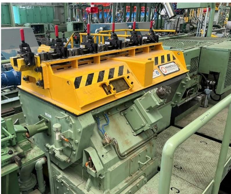
Eine der neuesten Lösungen von Primetals Technologies - das eDrive-Mini-Fertigwalzwerk.
