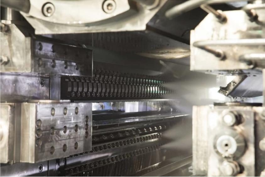
Распылительная система ISV от Primetals Technologies, установленная на стане прокатки алюминиевой фольги.
