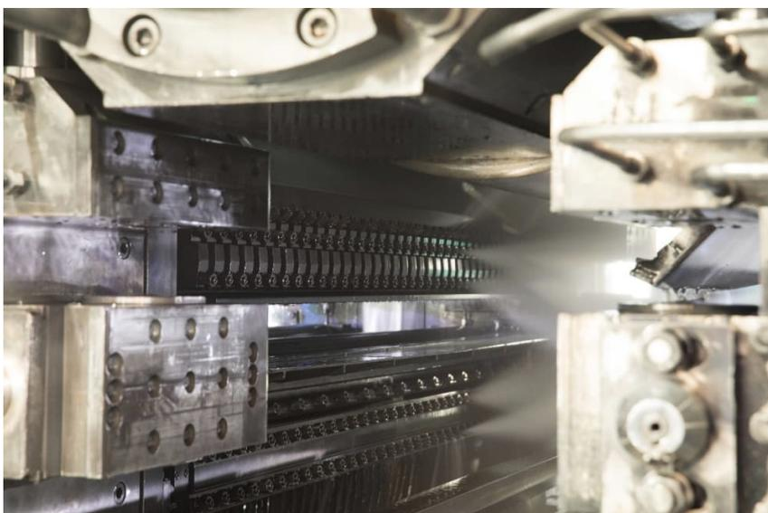
Sistema de spray ISV da Primetals Technologies instalado em um laminador de folha de alumínio.
