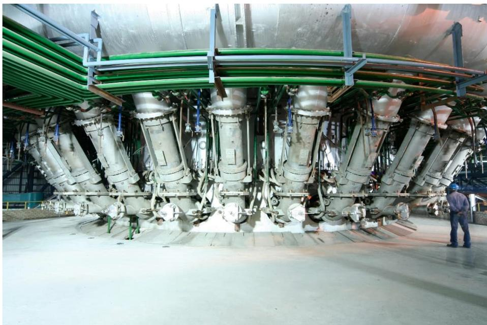
A Primetals Technologies realizará para a Hyundai Steel um estudo com foco no alto-forno da usina de Dangjin. A foto mostra a plataforma de ventaneiras do alto-forno.
