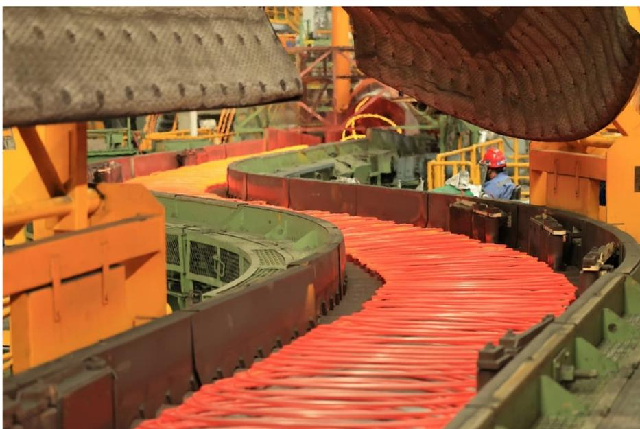
Seção curva do transportador Stelmor da Primetals Technologies para futuro processamento de tratamento de solução direta in-line.
