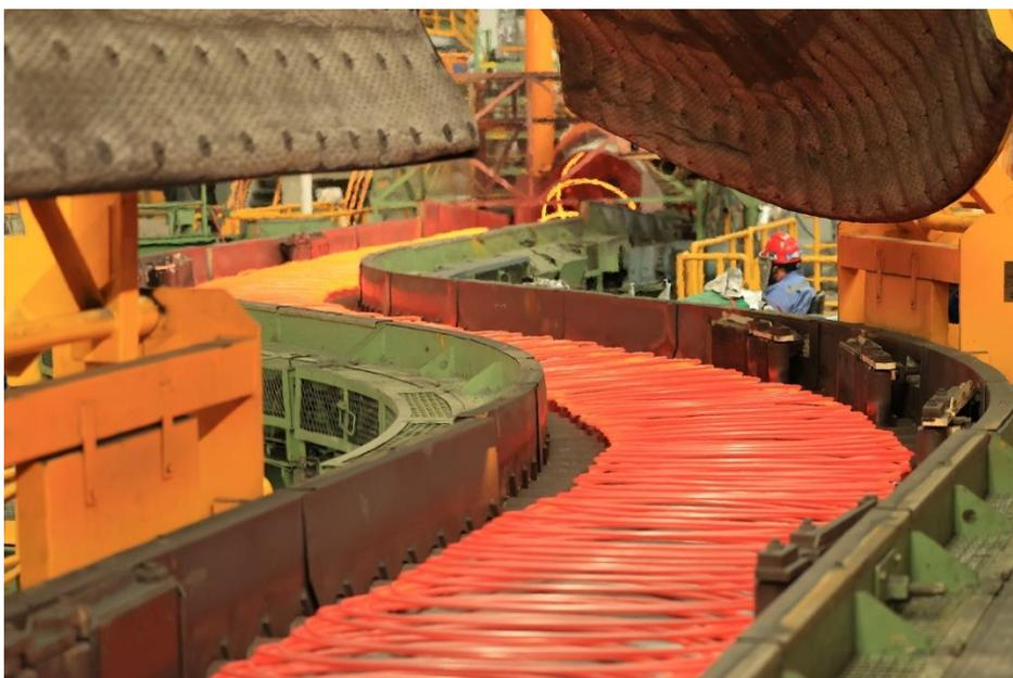
インライン DST 追設に対応するプライメタルズ テクノロジーズのステルモアコンベヤの湾曲部分
