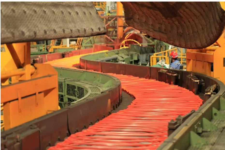
Kurvenförmiger Fördererabschnitt zur Beschickung des Stelmor-Förderers von Primetals Technologies.
