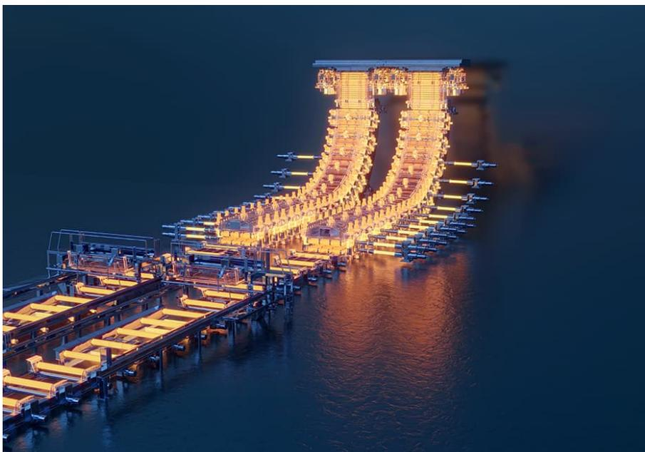
普锐特冶金技术将为宝钢提供既能生产普通钢也能生产硅钢的双流连铸机。
