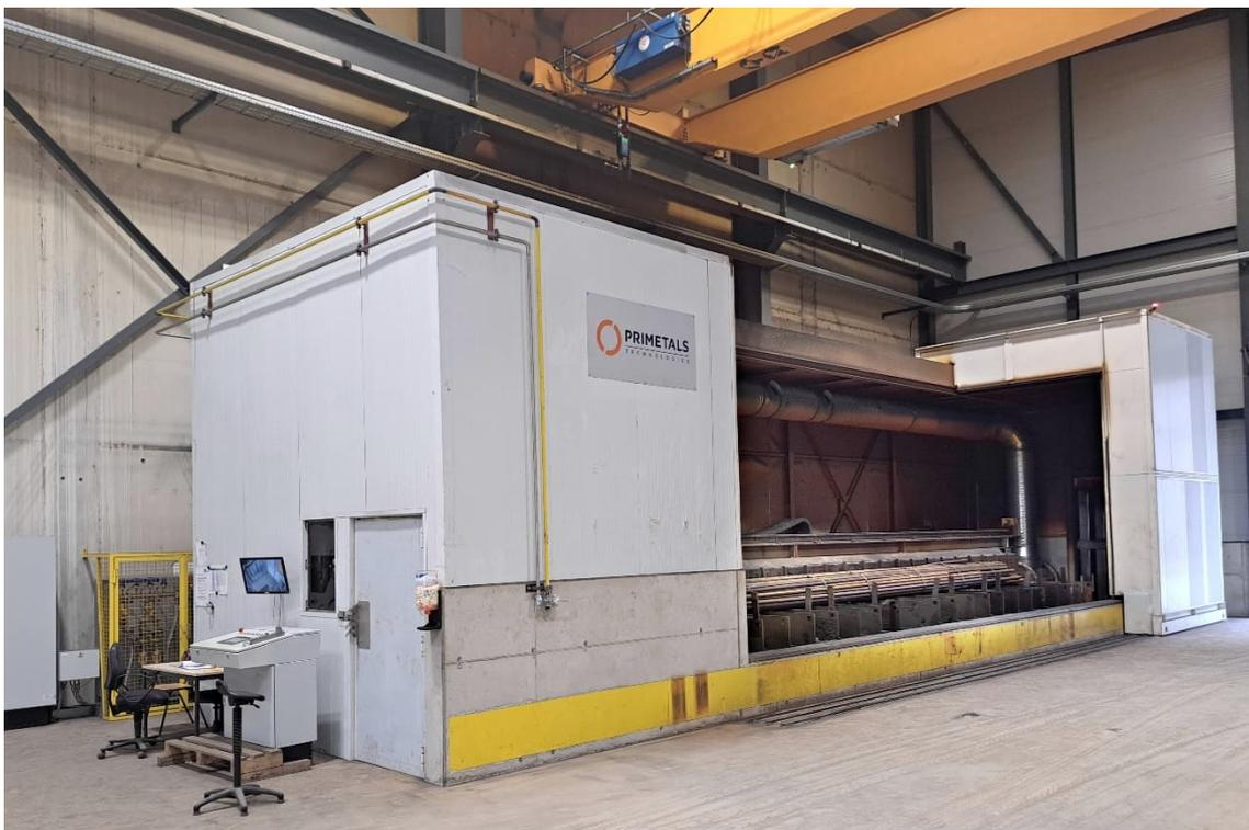
Машина Primetals Technologies для газокислородной резки скрапа обеспечивает существенное сокращение уровней шума и оптимизацию процесса сортировки скрапа и ведения скрапного хозяйства.
