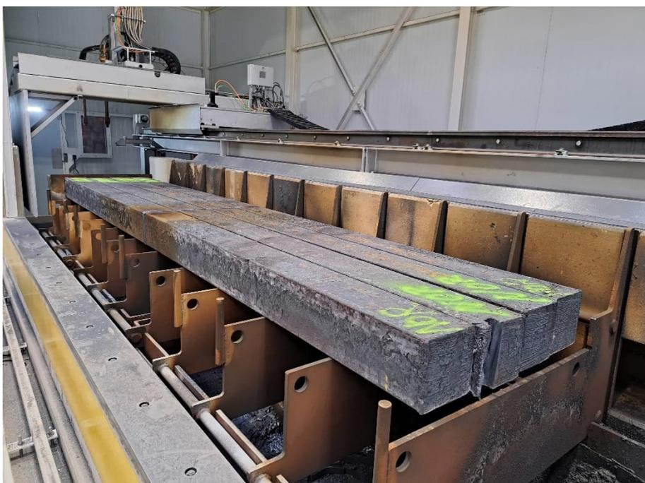
Машина для газовой резки скрапа от Primetals Technologies обрабатывает различные виды скрапа, в том числе сортовые заготовки, пачки катаных прутков, стальковши и настыль из промковша.
