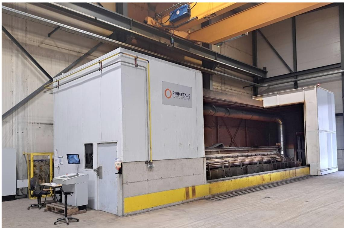
A máquina de corte a maçarico de sucata da Primetals Technologies reduz significativamente os níveis de barulho e simplifica o processo de triagem e gestão de sucata.
