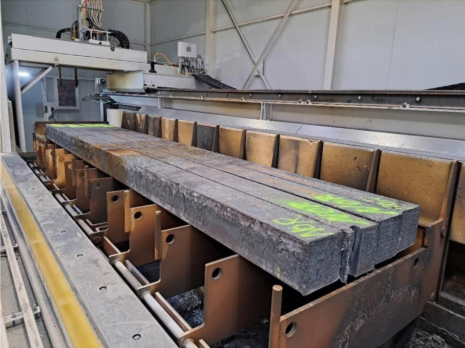
A máquina de corte a maçarico de sucata da Primetals Technologies processa vários tipos de sucata, incluindo tarugos, feixes de barra laminada e cascão de painéis de aço e de tundish de máquinas de lingotamento contínuo.
