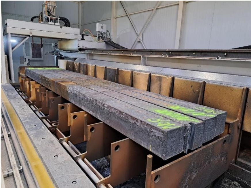
プライメタルズ テクノロジーズのスクラップトーチ切断機は、ビレット、圧延棒鋼の束、レードルおよびタンディッシュスカルなど、さまざまな種類のスクラップに対応しています。
