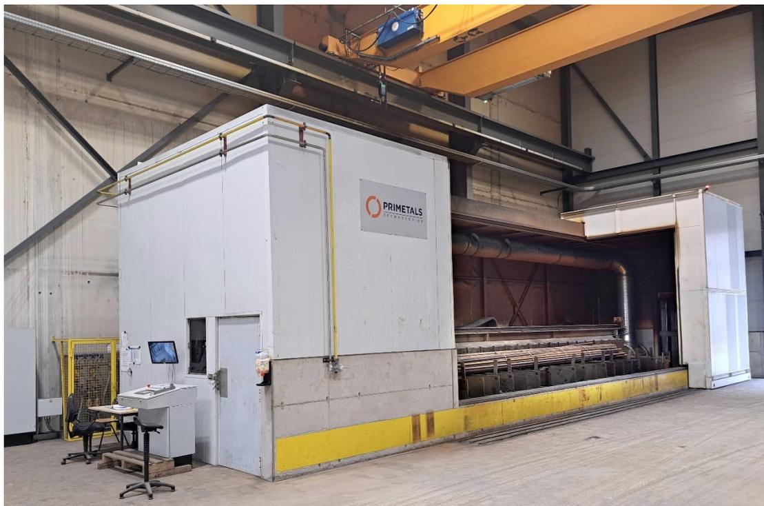
普锐特冶金技术提供的废料火焰切割机能够大幅降低噪音水平并简化废料分类和管理流程。
