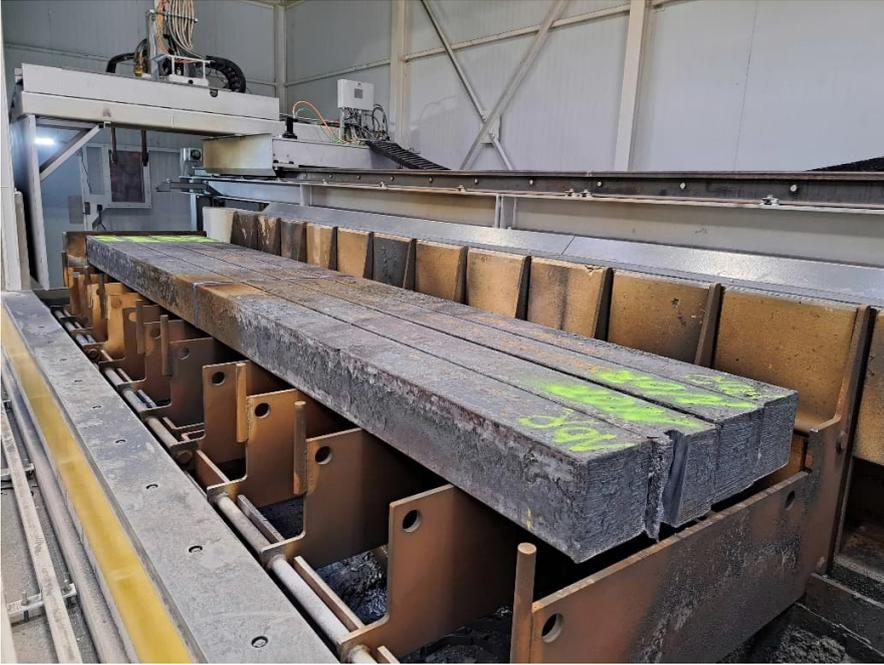
普锐特冶金技术提供的废料火焰切割机能够处理各种类型的废料，包括钢坯、成捆的轧制棒材以及钢包和中间包凝壳。
