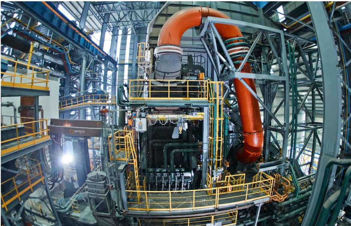
プライメタルズ テクノロジーズ製 EAF Quantum は 2014 年以來 TYASA で 77,000 ヒートを達成。EAF Quantum は運転コストと CO2 排出量の低減を特徴としています。
