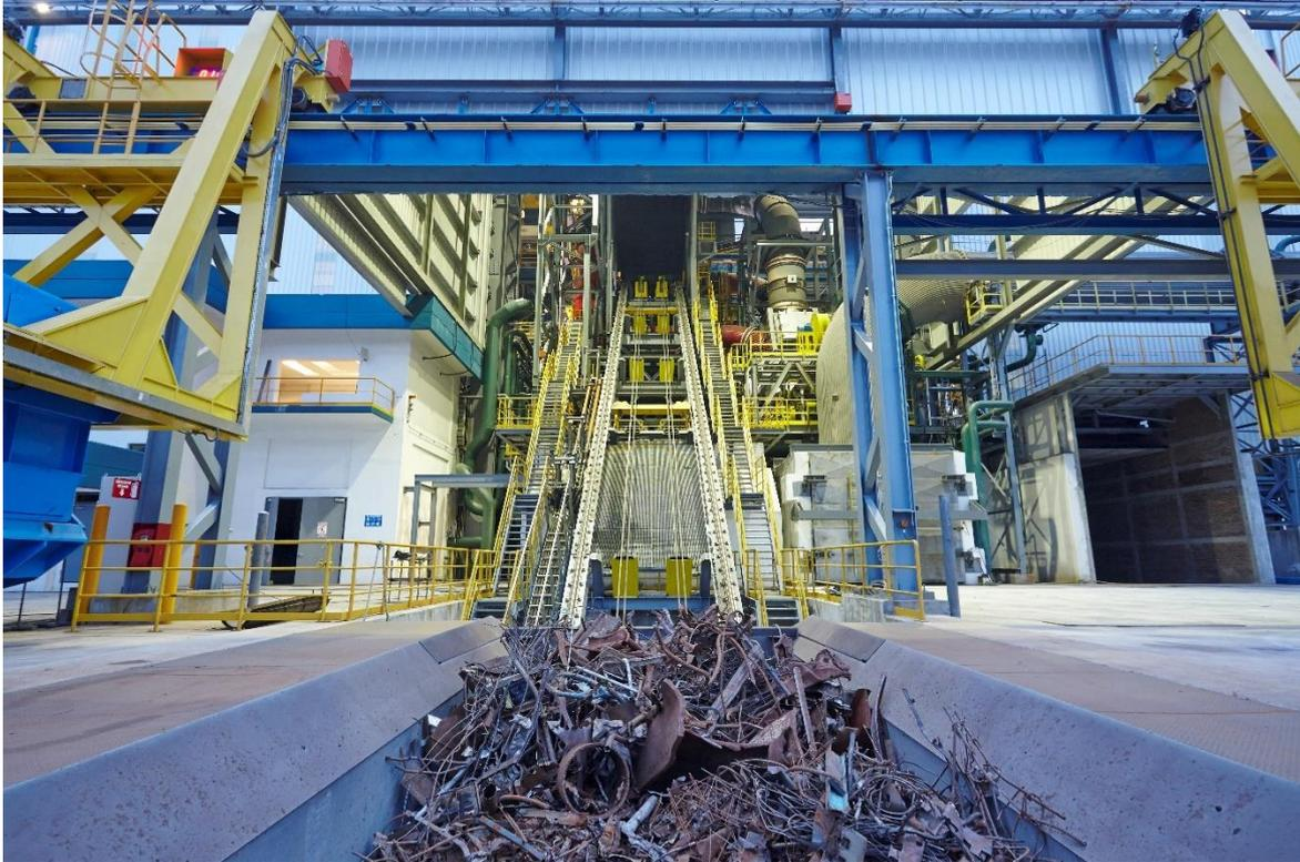
EAF Quantum は、革新的なシャフト（スクラップ予熱装置）を経由して、最適なタイミングでスクラップを炉に装入するよう設計されているため、理想的なフラットバス操業の継続が可能です。
