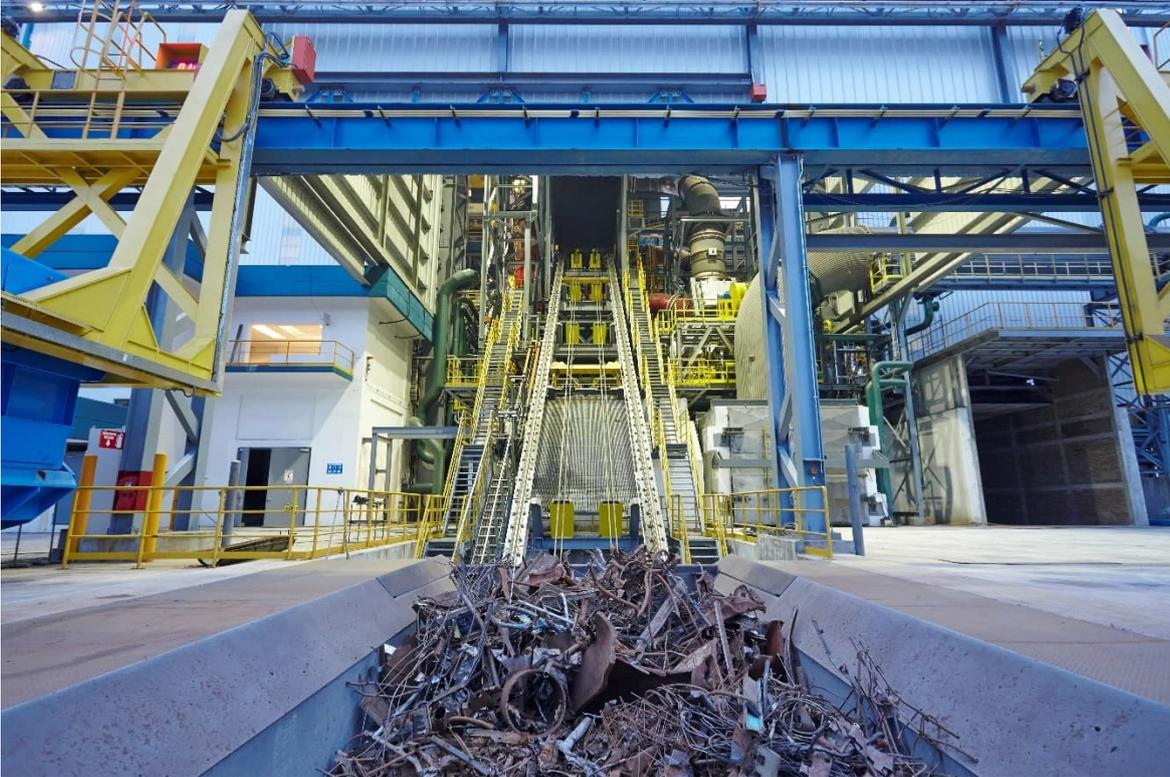
Der EAF Quantum ist so konzipiert, dass der Schrott zum optimalen Zeitpunkt während des Betriebes über den innovativen Schacht in den laufenden Ofen chargiert wird. Das Ergebnis ist ein kontinuierlicher Betrieb mit idealen Flachbadbedingungen.
