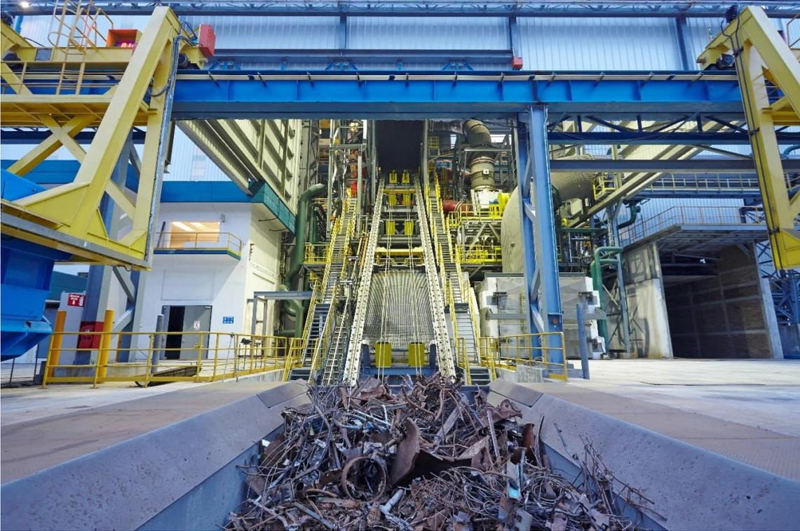
量子电炉的设计使废钢能够通过创新性的竖炉在最佳时间段装入正在运行的炉膛内。这就保证了始终在理想的平熔池条件下运行。
