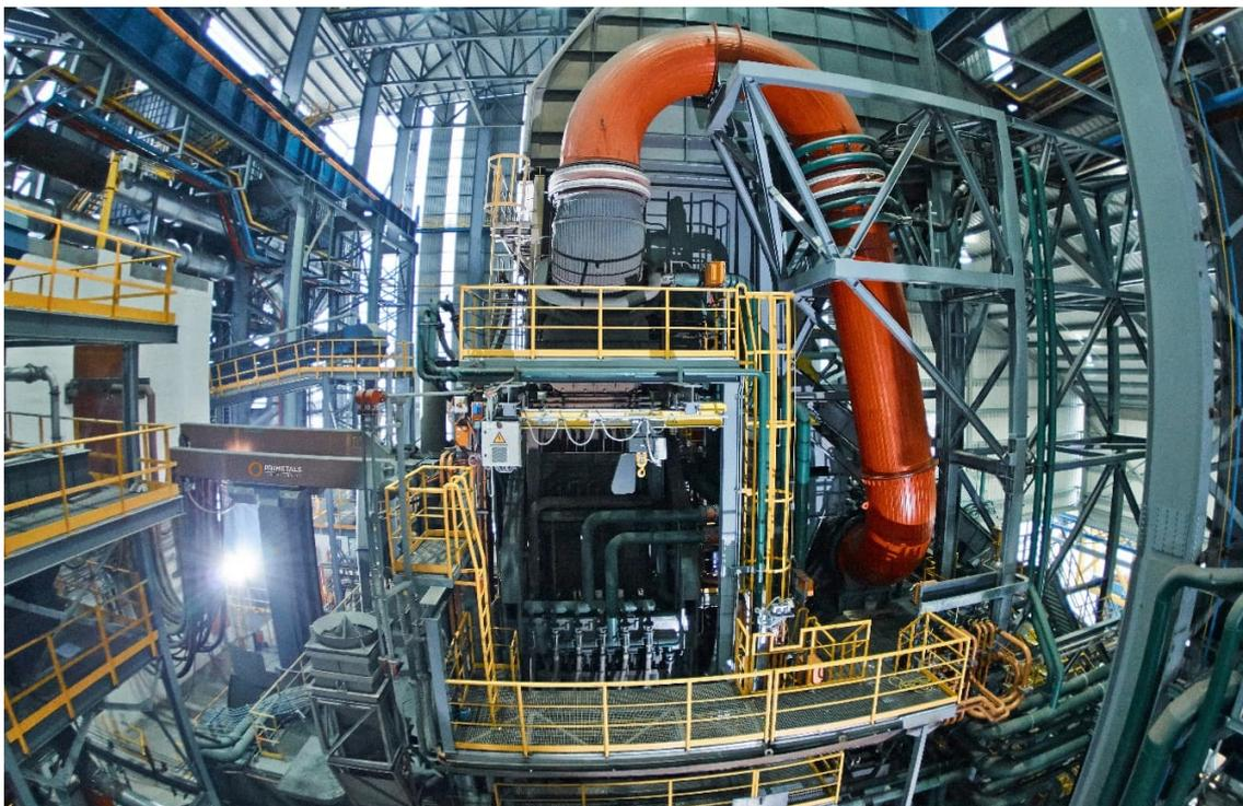
2014 年以来，TYASA 的普锐特冶金技术量子电炉已经生产了 77,000 炉。量子电炉的特点是运行成本低，CO<sub>2</sub> 排放少。
