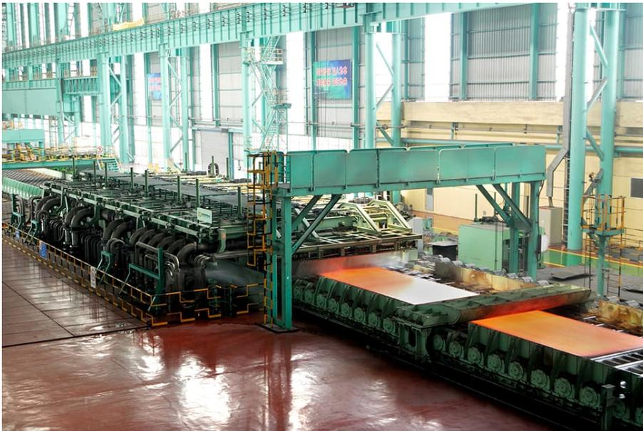
MULPIC - die weltweit führende Blechkuhltechnologie von Primetals Technologies.
