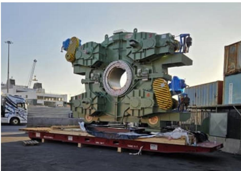
Новый привод наклона конвертера по пути в Южную Корею в виде единого 110-тонного блока.
