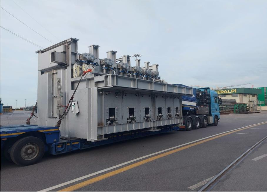
普锐特冶金技术将这台 6 流小方坯连铸机的弧形段设计成一个整体，以确保最大限度缩短停产时间。
