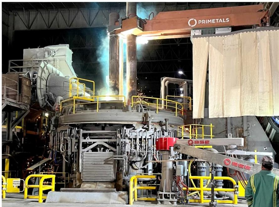
118-тонная ДСП, переоборудованная Primetals Technologies, в ходе первой плавки.
