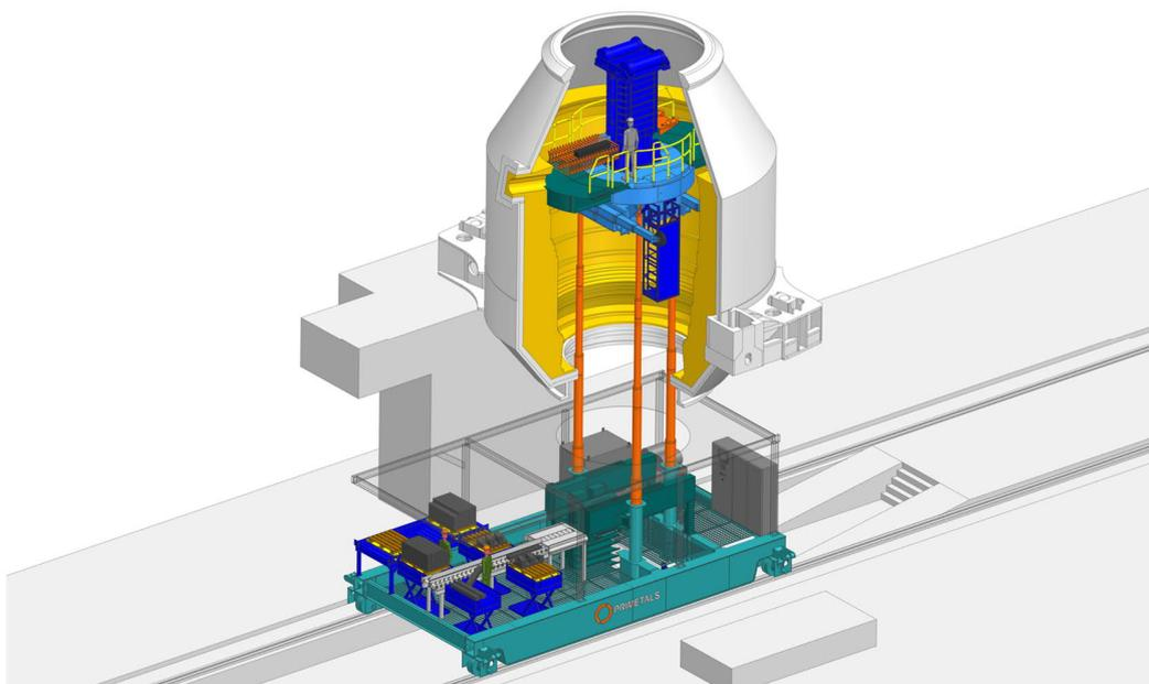
レンガを扱う作業の自動化ソリューションを搭載したプライメタルズ テクノロジーズ製 HKM 向けライニング設備
