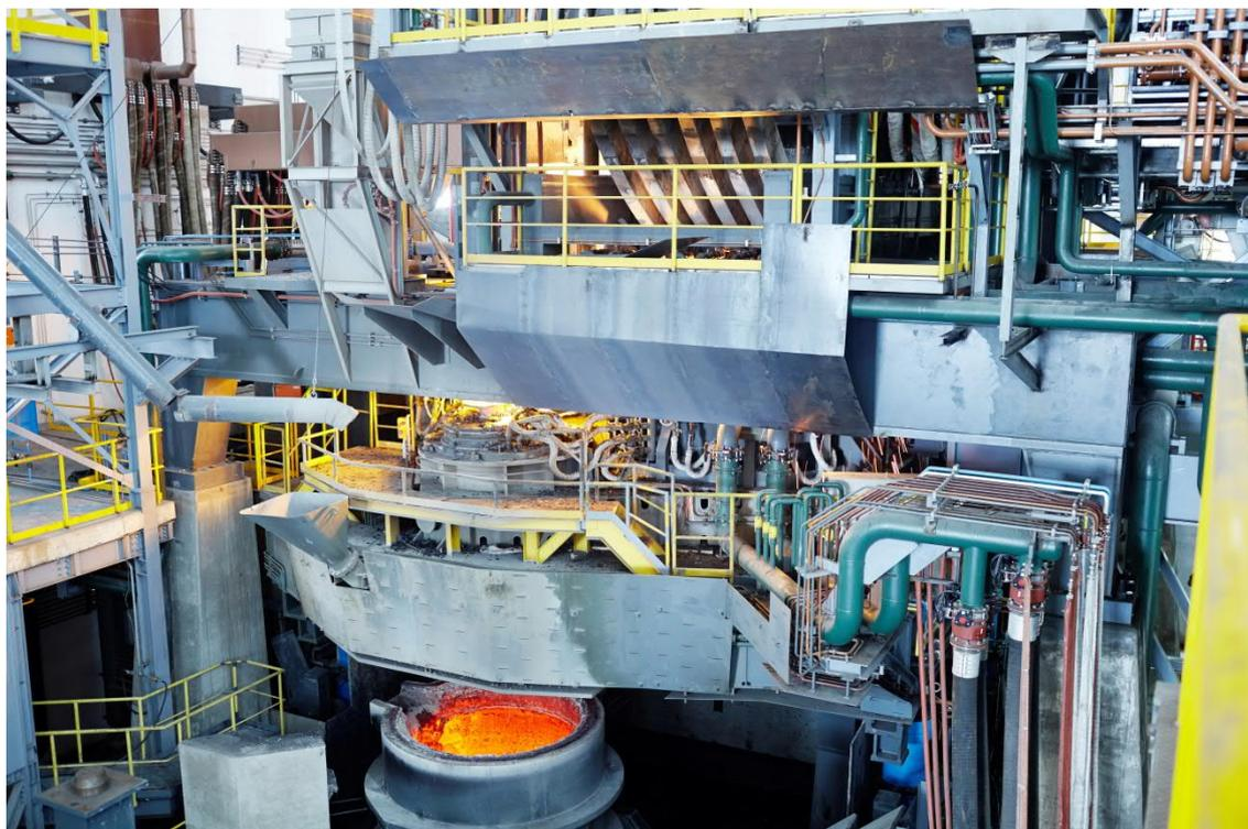
Forno elétrico a arco Quantum da Primetals Technologies
