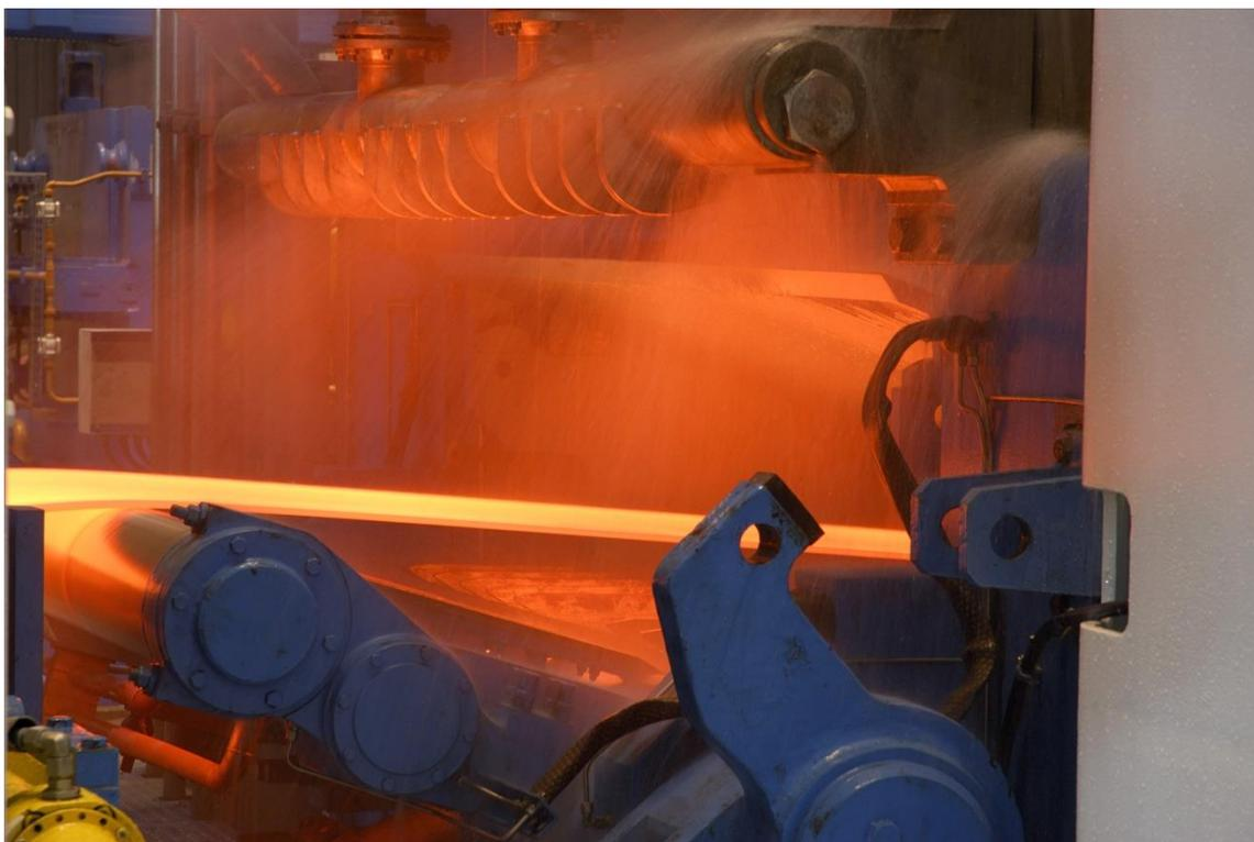
Стан горячей прокатки полосы от Primetals Technologies
