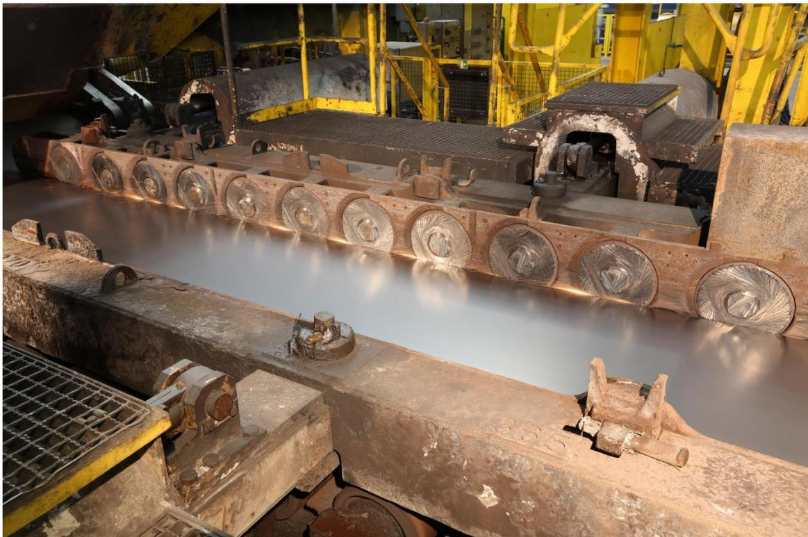
Боковые направляющие с дисками Eco Slide от Primetals Technologies на входной секции моталки стана горячей прокатки полосы на предприятии Voestalpine Stahl в Линце, Австрия.
