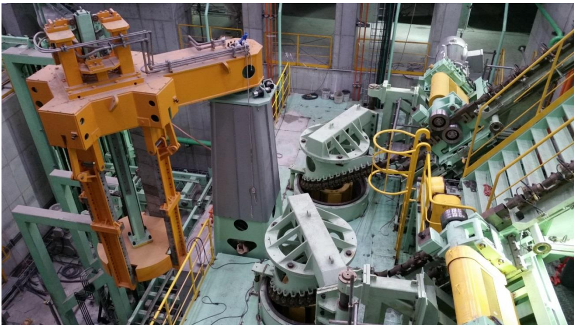
Zwei Aufspulvorrichtungen und Transfersystem für Ringmaterial von Primetals Technologies
