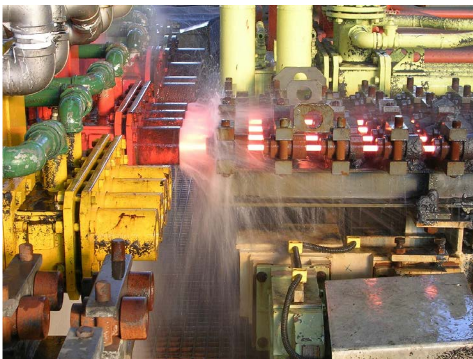
O sistema de tratamento térmico PQS em operação multi-veios em um laminador de barras da Primetals Technologies
