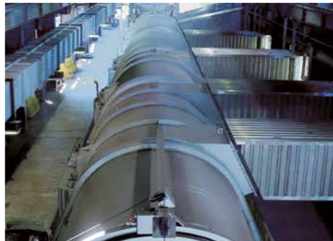
Gas-tight waste-gas recirculation hood
